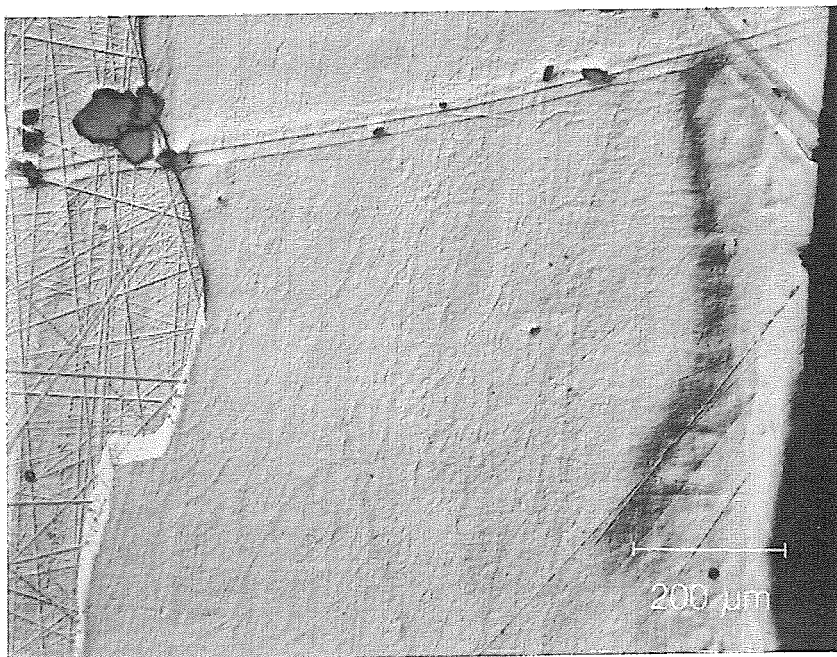
Abbildung E.6: Probe 5-1, Phasengrenze flüssig–fest, rechter Rand der Probe, wie oben. (Kap. 6.4.1)
