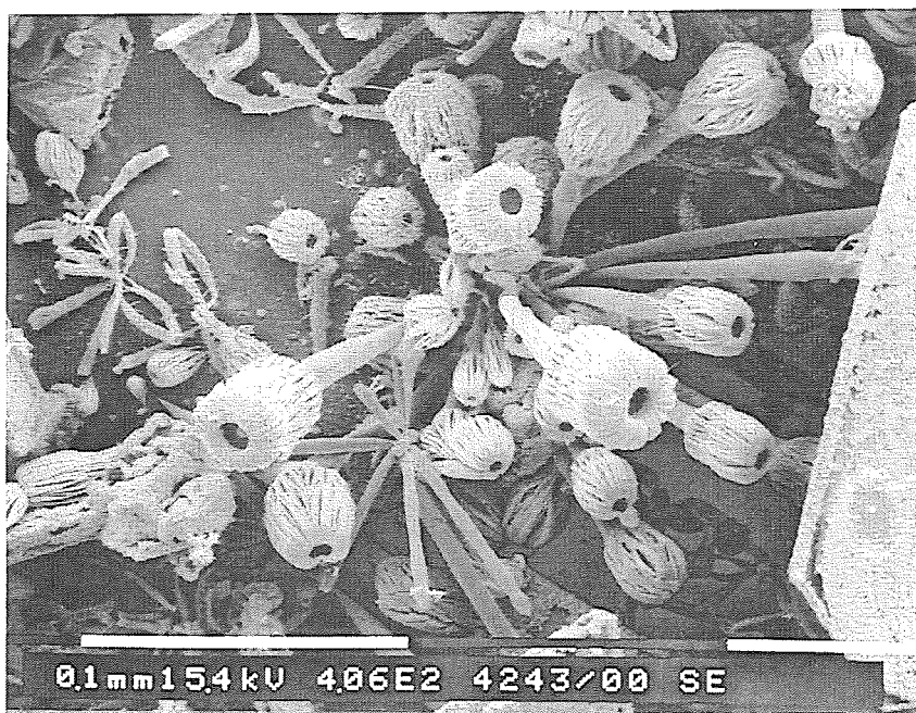
Abbildung E.41: Erstarrte Ga-As-Si Schmelze, Strukturen auf der Oberfläche (3). (Kap. 6.4.11)
