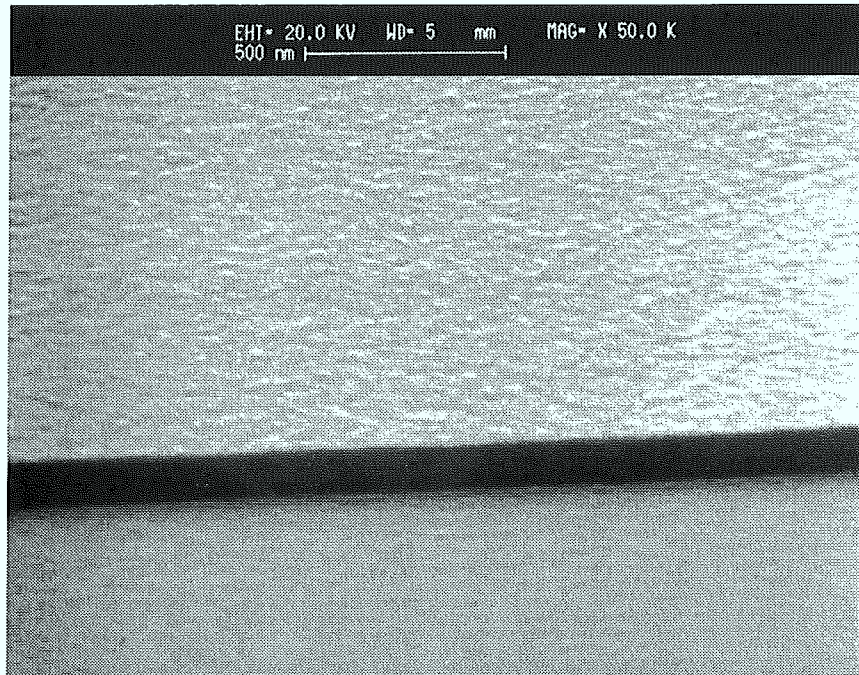
Abb. 3.13 Nb-Film auf Si-Substrat: Der Metallfilm wurde unter identischen Bedingungen deponiert wie der in Abbildung 3.18 gezeigte, ist aber auffallend glatter.
