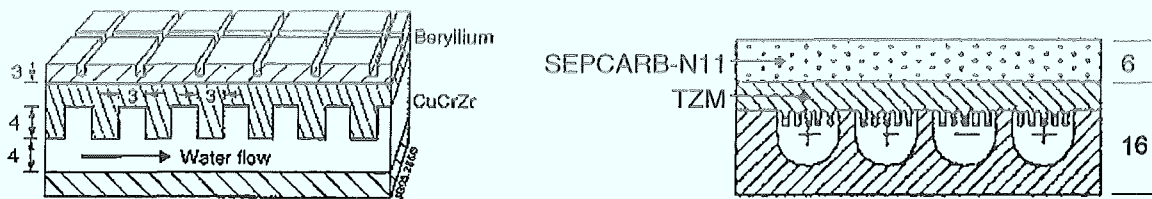
Abbildung 1.8: Vergleich einer Kühlstruktur für JET (links, aus [131]) mit dem aktuellen Divertor- Kühlkonzept von W7X (rechts [132]).
