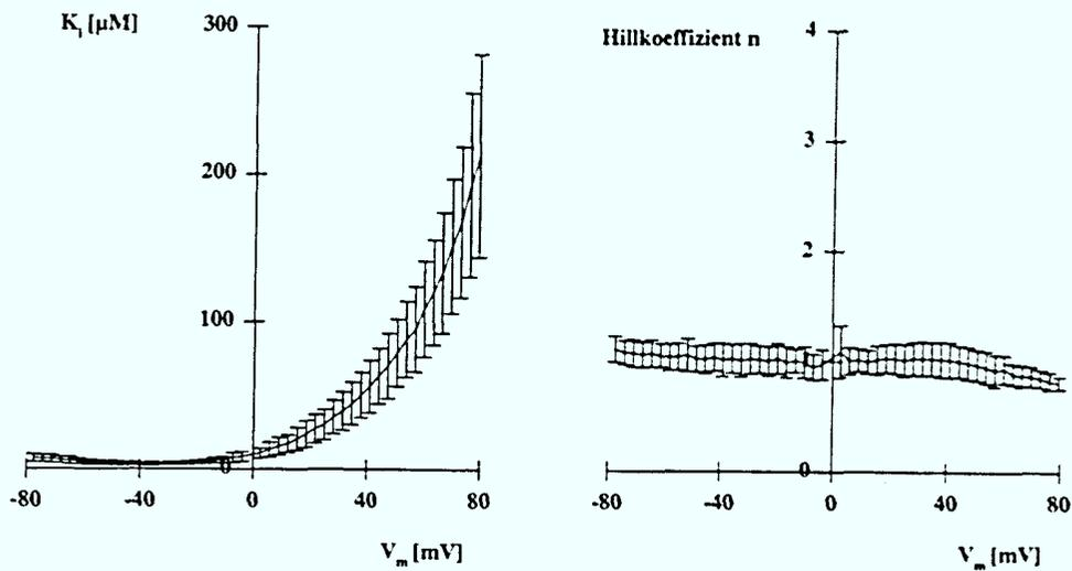
Abb.3.1.4: Spannungsabhängigkeit der Blockierungskonstante  $K_i$  (links) und des Hillkoeffizienten  $n$  (rechts) für  $\text{brengc}\alpha$ . Mittelwerte und Standardabweichung aus 9 Versuchen.
