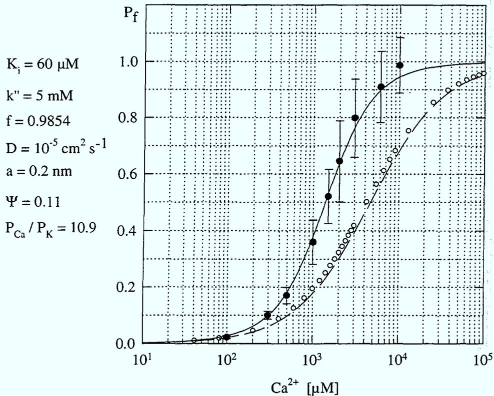
Abb.3.5.5: Vergleich der gemessenen  $\text{Ca}^{2+}$ -Abhängigkeit von  $P_f$  (●) mit der Berechnung nach GHK (Gl(7)) (gestrichelte Linie) und nach Gl(12) (o), und nach Gl(16) (durchgezogene Linie). Die Parameter für die Berechnung sind links neben der Abbildung angegeben (Daten von C. Dzeja).
