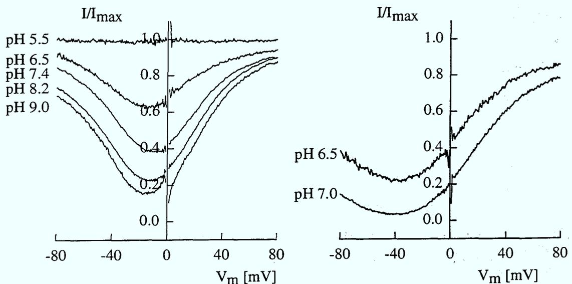
Abb.3.3.1: Spannungsabhängigkeit von  $I/I_{max}$  bei  $50 \mu M [Ca^{2+}]_a$  unter variierenden symmetrischen pH-Bedingungen für bocngc $\alpha$  (links) und brngc $\alpha$  (rechts). Die Kurven sind Mittelwerte aus mindestens fünf (bocngc $\alpha$ ) bzw. drei (brngc $\alpha$ ) Versuchen.
