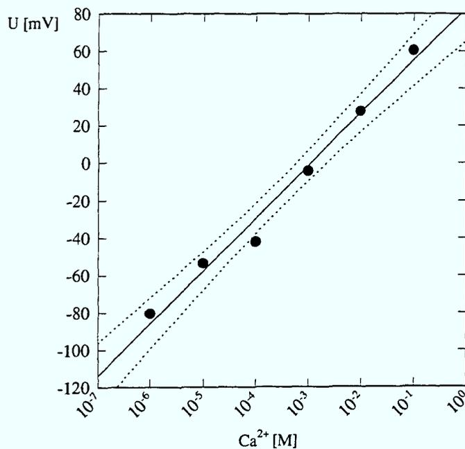
Abb.2.4.1: Eichkurve für die Bestimmung der freien  $\text{Ca}^{2+}$ -Konzentration mit einer  $\text{Ca}^{2+}$ -Elektrode. Die Meßwerte sind Mittelwerte aus mindestens drei aufeinanderfolgenden Bestimmungen. Die durchgezogene Linie ist eine lineare Regression, die gepunktete Linie zeigt das Konfidenzintervall der Regression.
