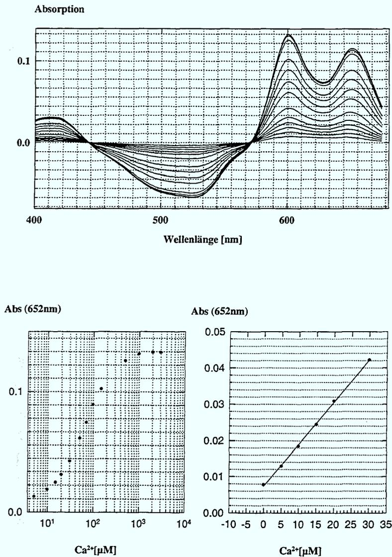
Abb.2.4.2: Eichkurve für die  $\text{Ca}^{2+}$ -Bestimmung mit Arsenazo III. (oben): Absorptionsspektrum von Arsenazo III für verschiedene  $\text{Ca}^{2+}$ -Konzentrationen. (unten):  $\text{Ca}^{2+}$ -Abhängigkeit der Absorption bei 652 nm.
