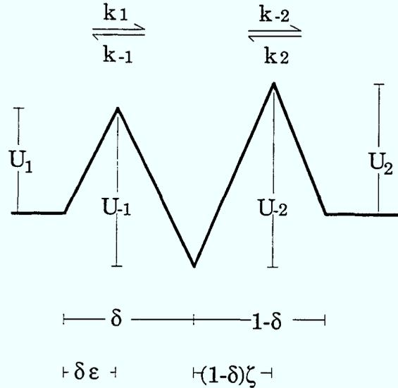
Abb.2.6.1: Schematisches Modell der cng-Kanalpore, repräsentiert durch Energiebarrieren  $U_i$  und Lage der Energiemaxima und -minima  $\delta$ ,  $\delta \epsilon$ ,  $(1-\delta) \zeta$ . Die permeierenden Ionen halten sich bevorzugt im Energieminimum (Bindestelle) auf. Besitzen sie genügend thermische Energie, um die Energiebarrieren zu überwinden, können sie die Pore wieder verlassen.
