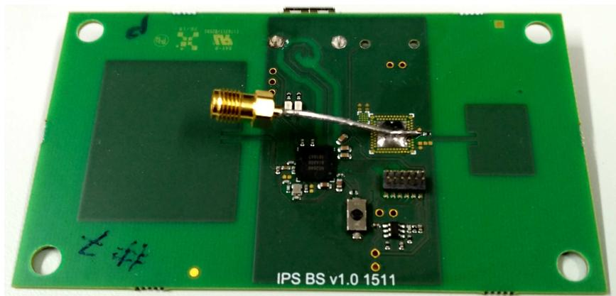
**Abbildung 3.6:** *Base Station* mit Patchantenne für Bluetooth bei 2,4 GHz (links) und Patchantenne für 5,8 GHz (rechts)
