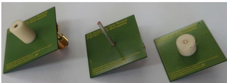
**Abbildung 3.2:** Verschiedene Varianten der Monopolantenne
