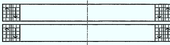
Abbildung 3.4: Radiallager mit Doppelmagnetringen
