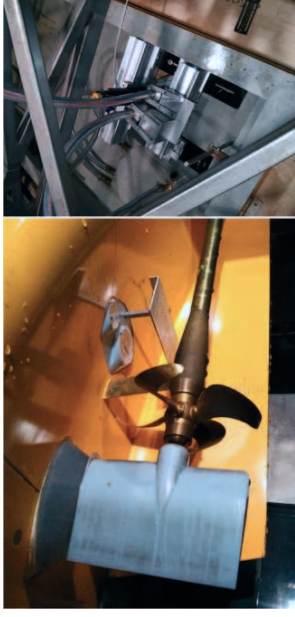
Abb. 12 - Nachstrommessungen im HyKat der HSWA – Kalibriertagert unterhalb der Fenstercheiben (links), Zwei Kameras mit Kabelzuführungsschläuchen plus Target/Traversengachse tauchbar fixiert im Schiffsmodell (rechts)
