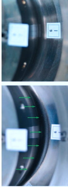
Abb. 18: Kühlraum des Kolbens der Serienausführung mit Verkokung (links) und der optimierten Ausführung ohne Verkokung (rechts).
