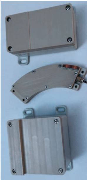
Abb. 4: Entwickelte Energy Harvesting Systeme im öldichten Gehäuse v.l.n.r. Antriebsharvester, Kupplungsharvester, Abtriebsharvester
