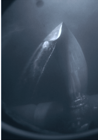
Abb. 15: Kavitationsbeobachtungen am Propeller der RoPax-Fähre
