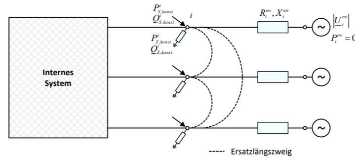
Abbildung 5.68: Extended-Ward-Ersatznetz [388]
