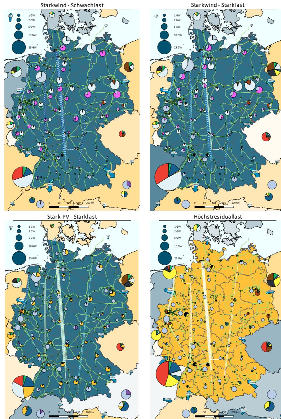
Abbildung 6.42: (n-1)-Ausfallrechnungen für spezifische Stunden im Jahr 2035
