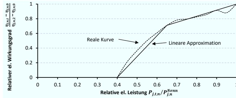
Abbildung 5.44: Relativer elektrischer Wirkungsgrad eines DKW im Teillastbetrieb [344]
