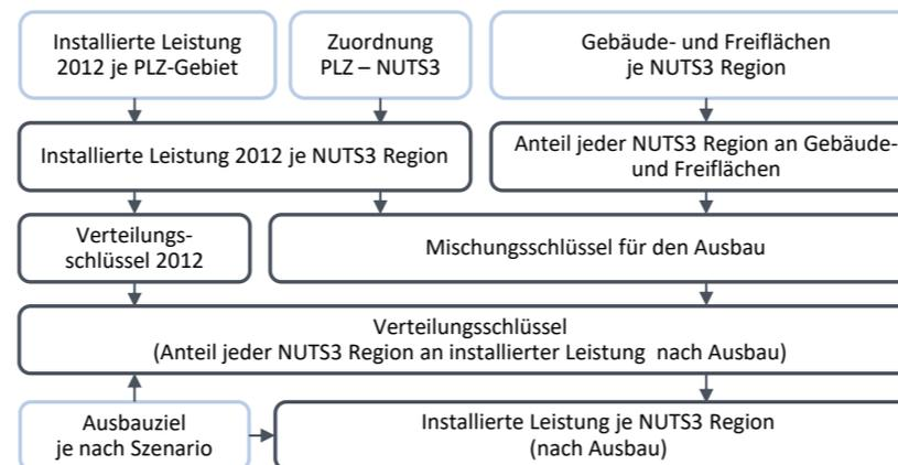
**Abbildung 5.26: Verfahrensablauf der Regionalisierung der installierten PV-Leistung**
