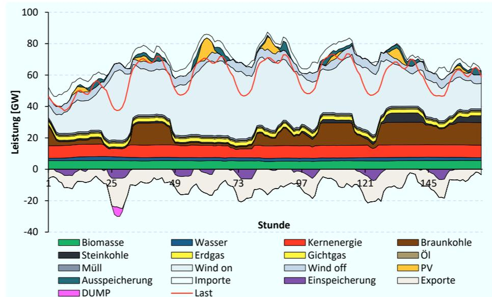
Abbildung 6.34: Woche im Jahr 2020 mit Starkwind-Starklast-Stunde (27) und Starkwind-Schwachlast-Stunde(65)
