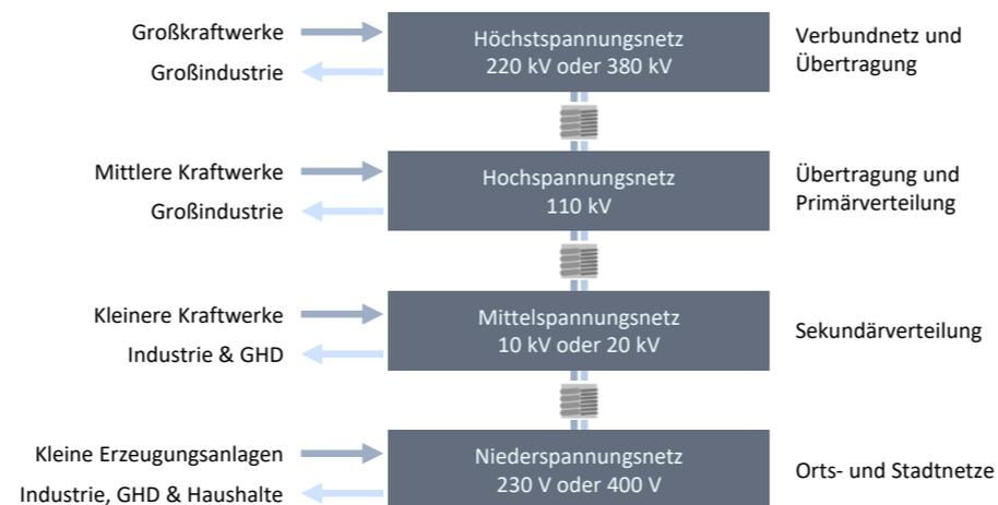
**Abbildung 2.9: Ebenen eines elektrischen Energieversorgungsnetzes [37, 42]**
