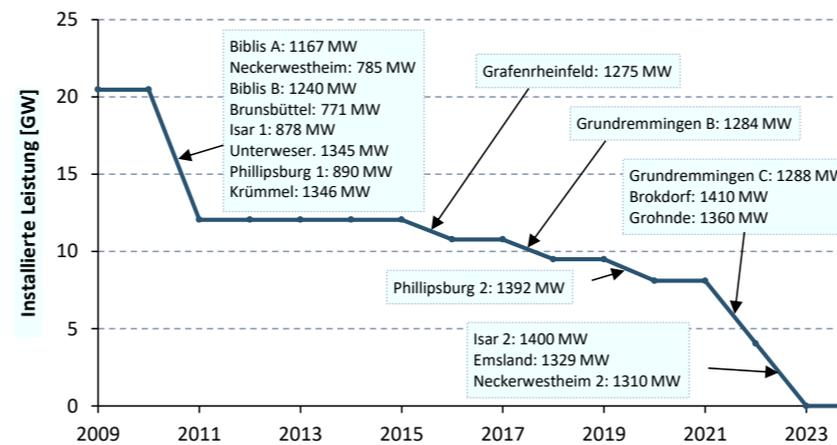
**Abbildung 6.2: Angenommene Entwicklung der Kernkraftwerkskapazitäten in Deutschland**
