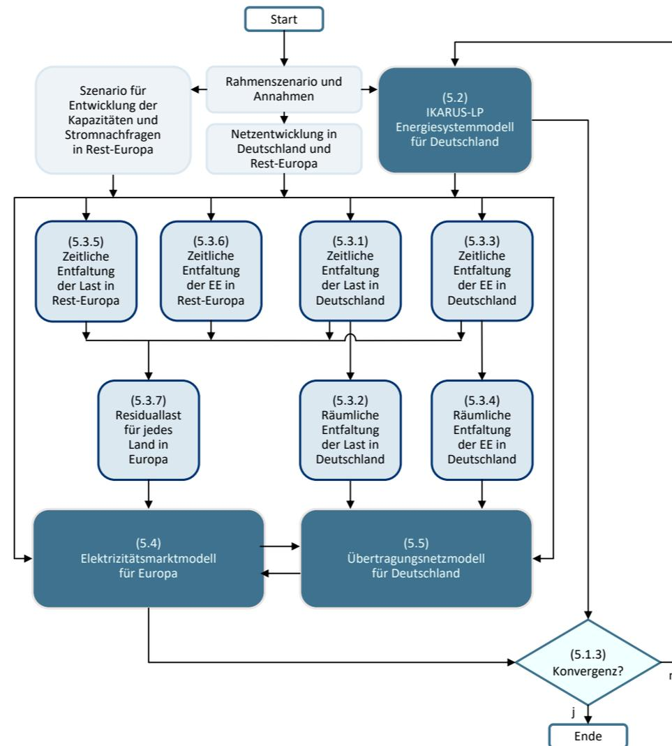
**Abbildung 5.4: Struktur des entwickelten Modellpakets**
