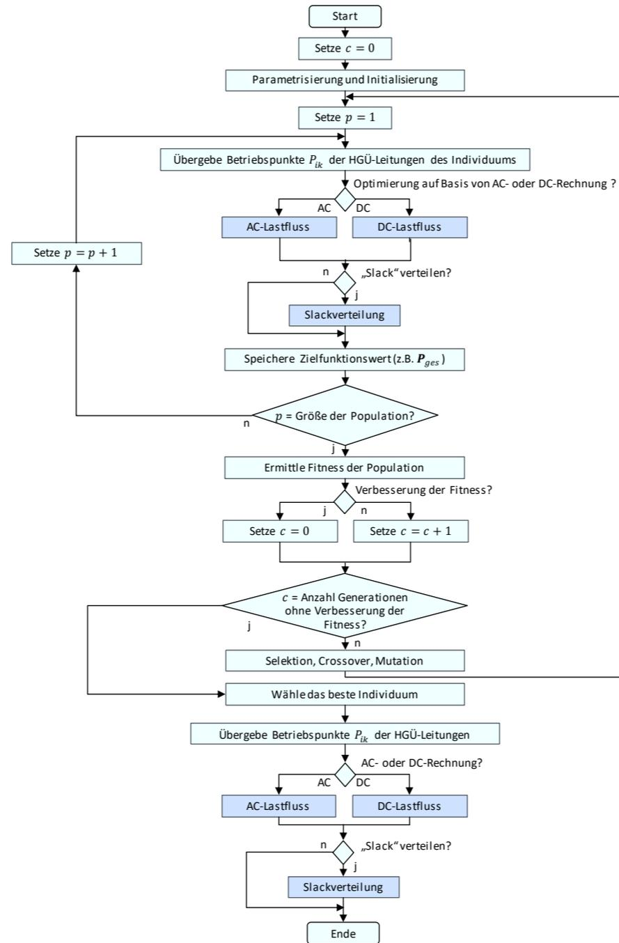
Abbildung 5.63 Verfahrensablauf der Prozedur *Hybrid-Lastfluss*
