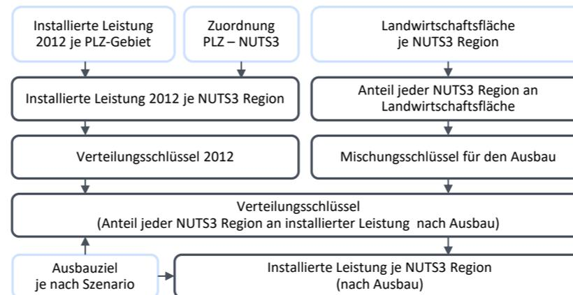
**Abbildung 5.27: Verfahrensablauf der Regionalisierung der installierten Biomasse-Leistung**
