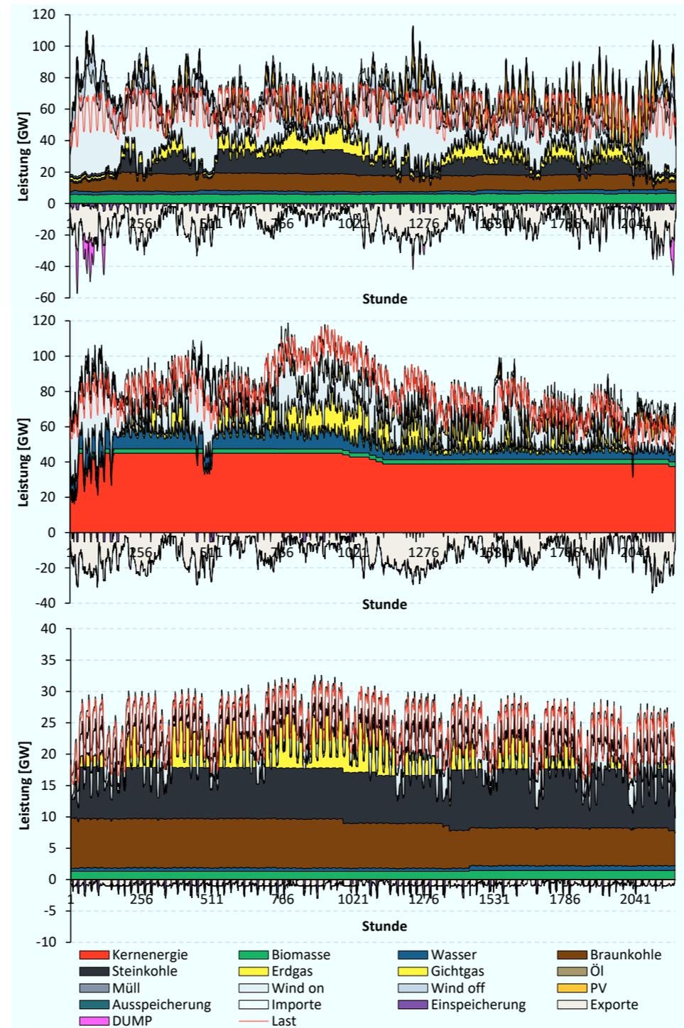
Abbildung 6.23: Nettostromerzeugung, Last sowie Im- und Exporte in Q1 2030 in DE, FR, PL
