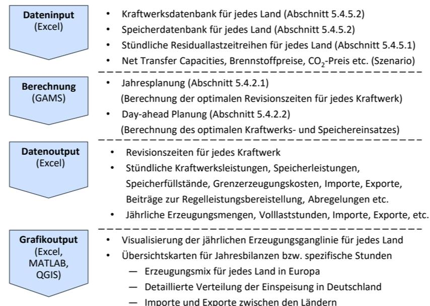
Abbildung 5.41: Einbindung des Elektrizitätsmarktmodells in das Modellpaket
