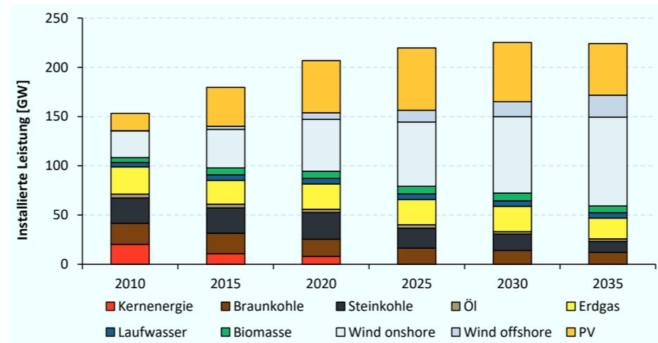
**Abbildung 6.27: Installierte Kraftwerksleistung nach Energieträgern (Modellpaket)**
