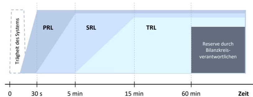
**Abbildung 2.16: Regelleistungsarten und deren zeitliches Ineinandergreifen [73]**
