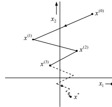
Abbildung 5.53: Iterationsschritte der Gauß-Seidel Iteration [357]
