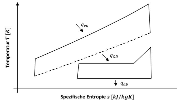
Abbildung 2.5: Gas- und Dampfturbinenprozess im T,s-Diagramm [8]
