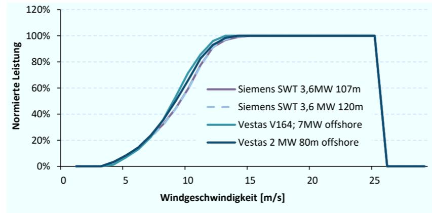
**Abbildung 5.19: Leistungskennlinien von Offshore Windenergieanlagen [230, 231]**
