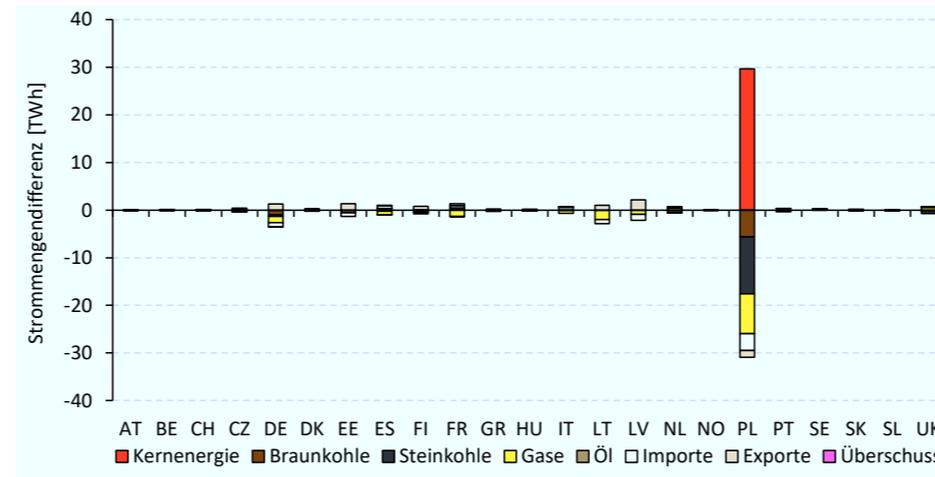
Abbildung 6.46: Differenzen der Nettostromerzeugungen sowie Im- und Exporte zwischen dem Szenario B und dem Basisszenario
