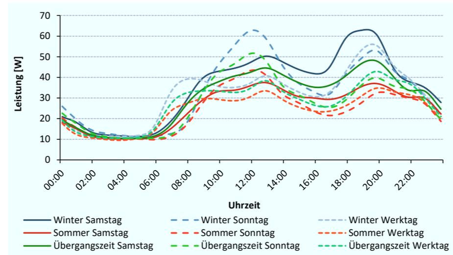
**Abbildung 5.12: Standardlastprofil HO für Haushalte (2012) [217]**
