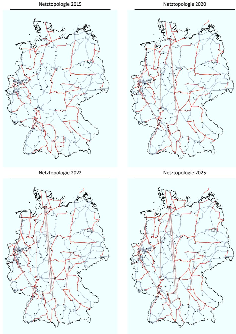
Abbildung 5.74: Entwicklung der Netztopologie in den Jahren 2015 – 2025 gemäß NEP 2012
