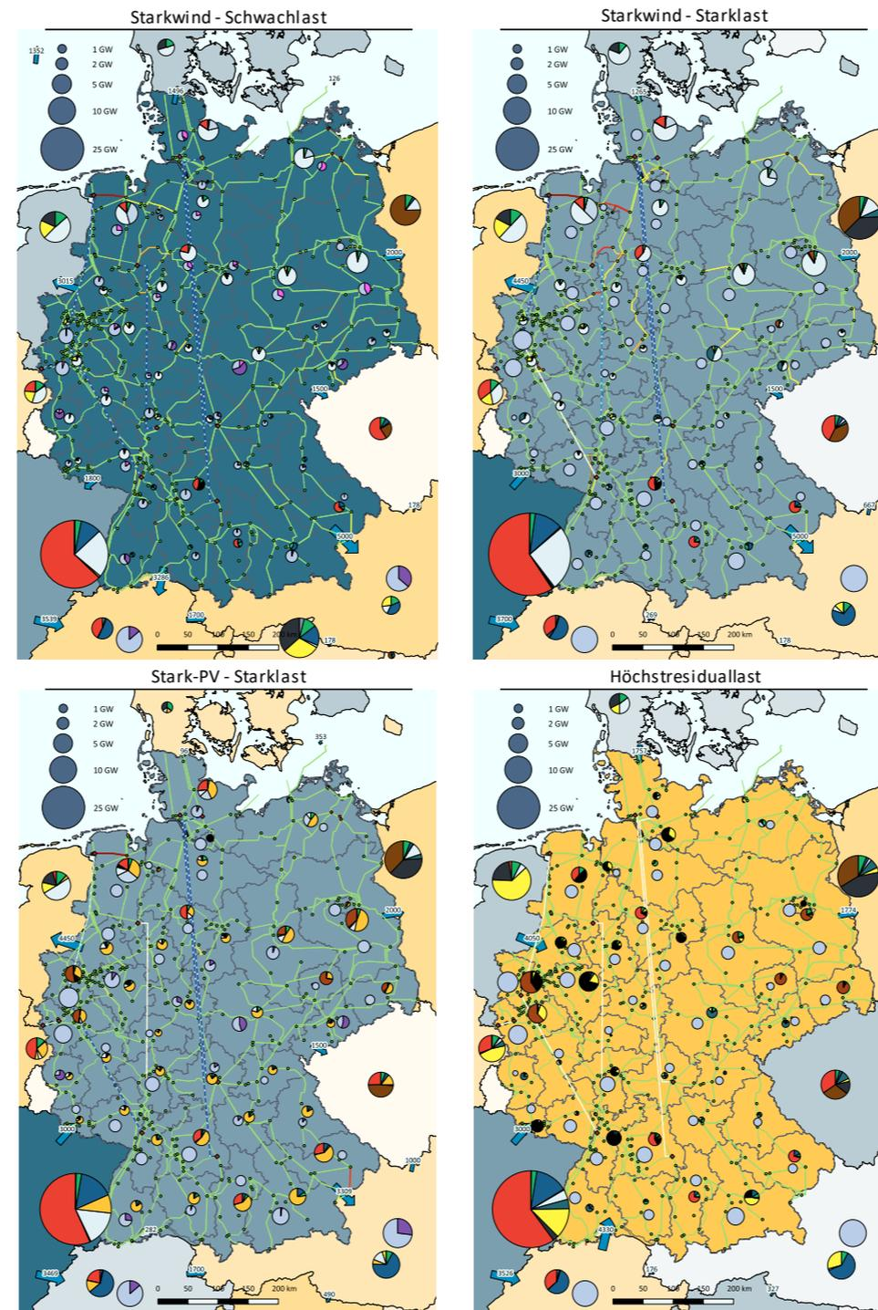
Abbildung 6.37: (n-1)-Ausfallrechnungen für spezifische Stunden im Jahr 2020
