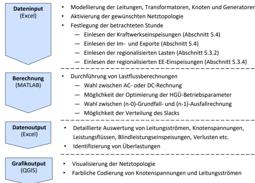
Abbildung 5.58: Einbindung des Übertragungsnetzmodells in das Modellpaket
