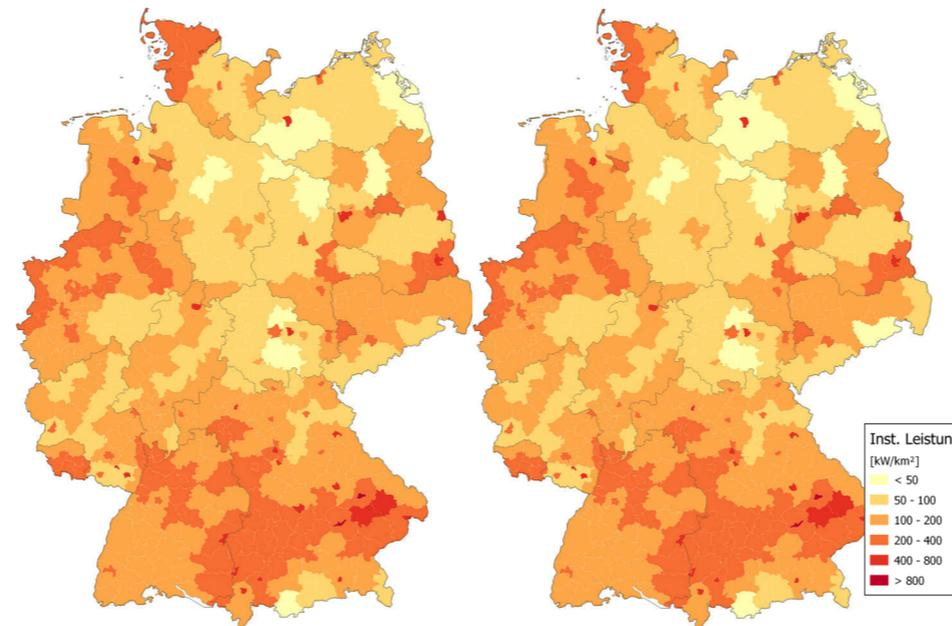
**Abbildung 6.4. Verteilung der installierten PV-Leistung 2020 (links) und 2035 (rechts)**
