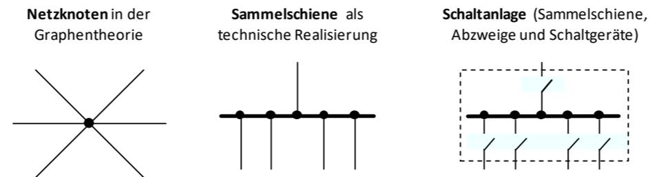
**Abbildung 2.13: Schaltanlage als Knotenpunkt im Netz [41]**
