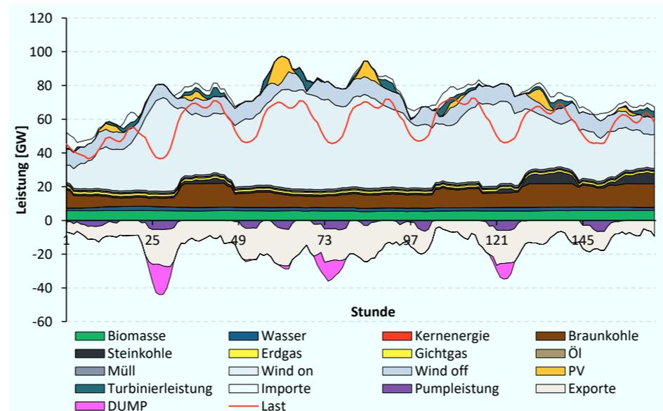
Abbildung B.9: Woche im Jahr 2025 mit Starkwind - Starklast (27) und Starkwind - Schwachlast (65)
