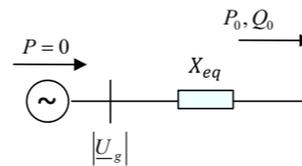
Abbildung 5.69: Blindleistungskompensations-Äquivalent [389]
