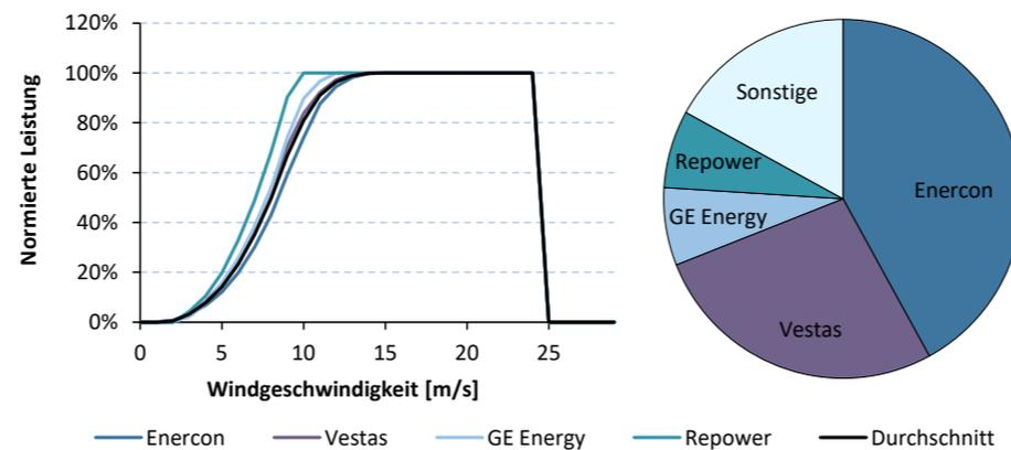
**Abbildung 5.30: Leistungskennlinien von WEA und Marktanteile der Anlagenhersteller [230, 231]**
