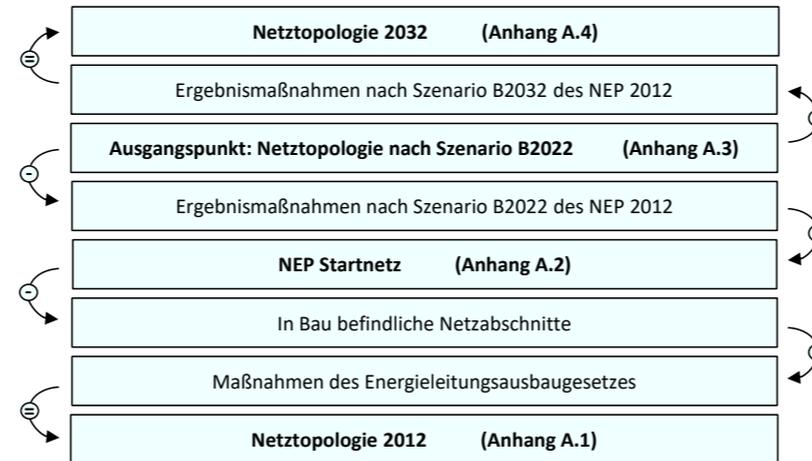
**Abbildung 5.72: Vorgehen bei der Modellierung der verschiedenen Netztopologien**
