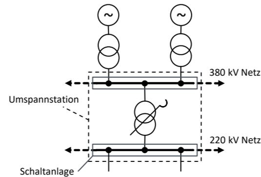
Abbildung 2.14: Umspannwerk in einem elektrischen Energieversorgungsnetz [41]
