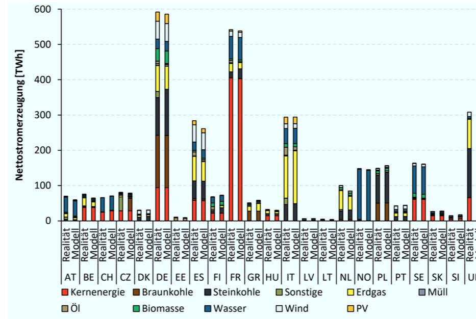
Abbildung 5.48: Ergebnis der Validierungsrechnung für das Jahr 2012 (Nettostromerzeugung)
