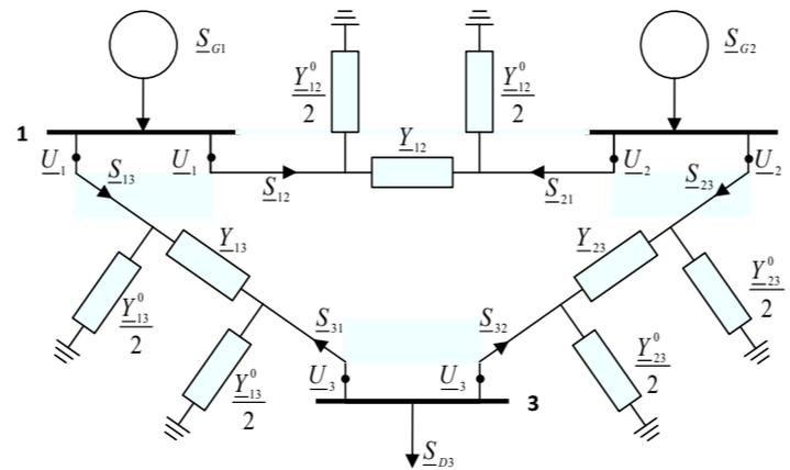
**Abbildung 5.50: Ersatzschaltbild eines Übertragungsnetzes mit drei Verteilschienen [357]**
