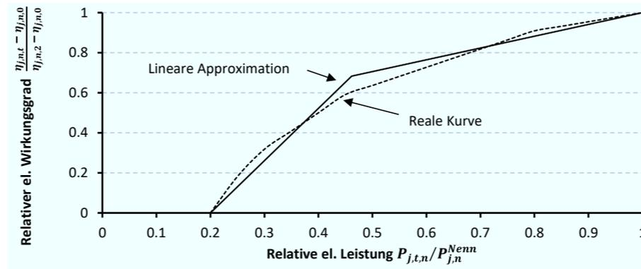
Abbildung 5.45: Relativer elektrischer Wirkungsgrad einer GT im Teillastbetrieb [345]
