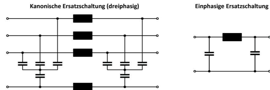
Abbildung 2.7: Ersatzschaltung der verlustlosen Drehstromfreileitung bei symmetrischem Betrieb [37]
