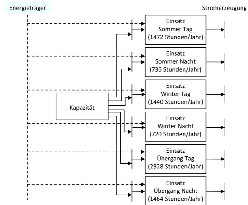
**Abbildung 5.9: Abbildung einer Stromerzeugungstechnologie im Stromsektor [204]**
