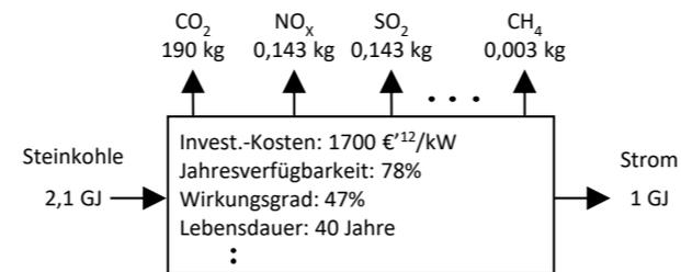
**Abbildung 5.8: Das Platzhalterkonzept am Beispiel eines modernen Steinkohlekraftwerks**
