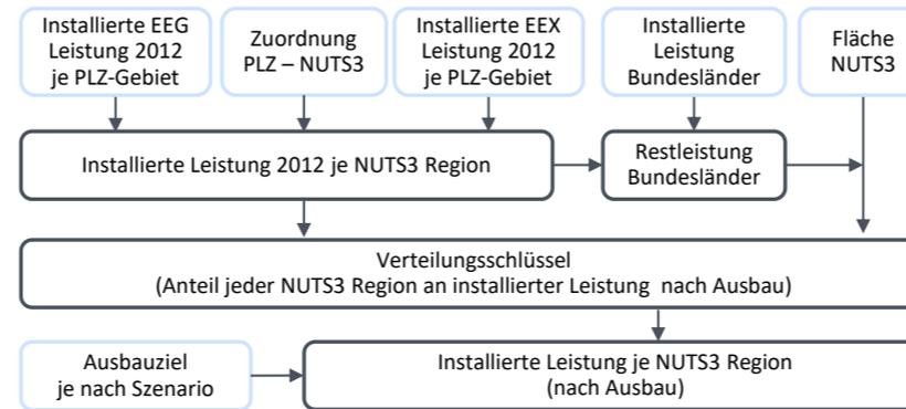
Abbildung 5.28: Verfahrensablauf der Regionalisierung der installierten Laufwasser-Leistung
