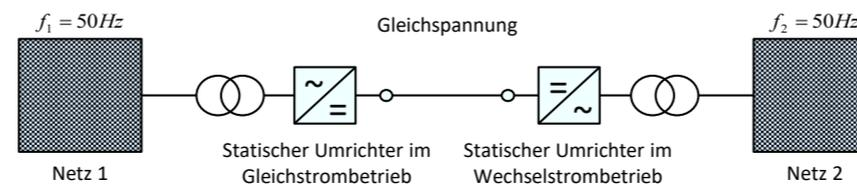
Abbildung 2.8: Prinzipieller Aufbau von HGÜ-Anlagen [38]
