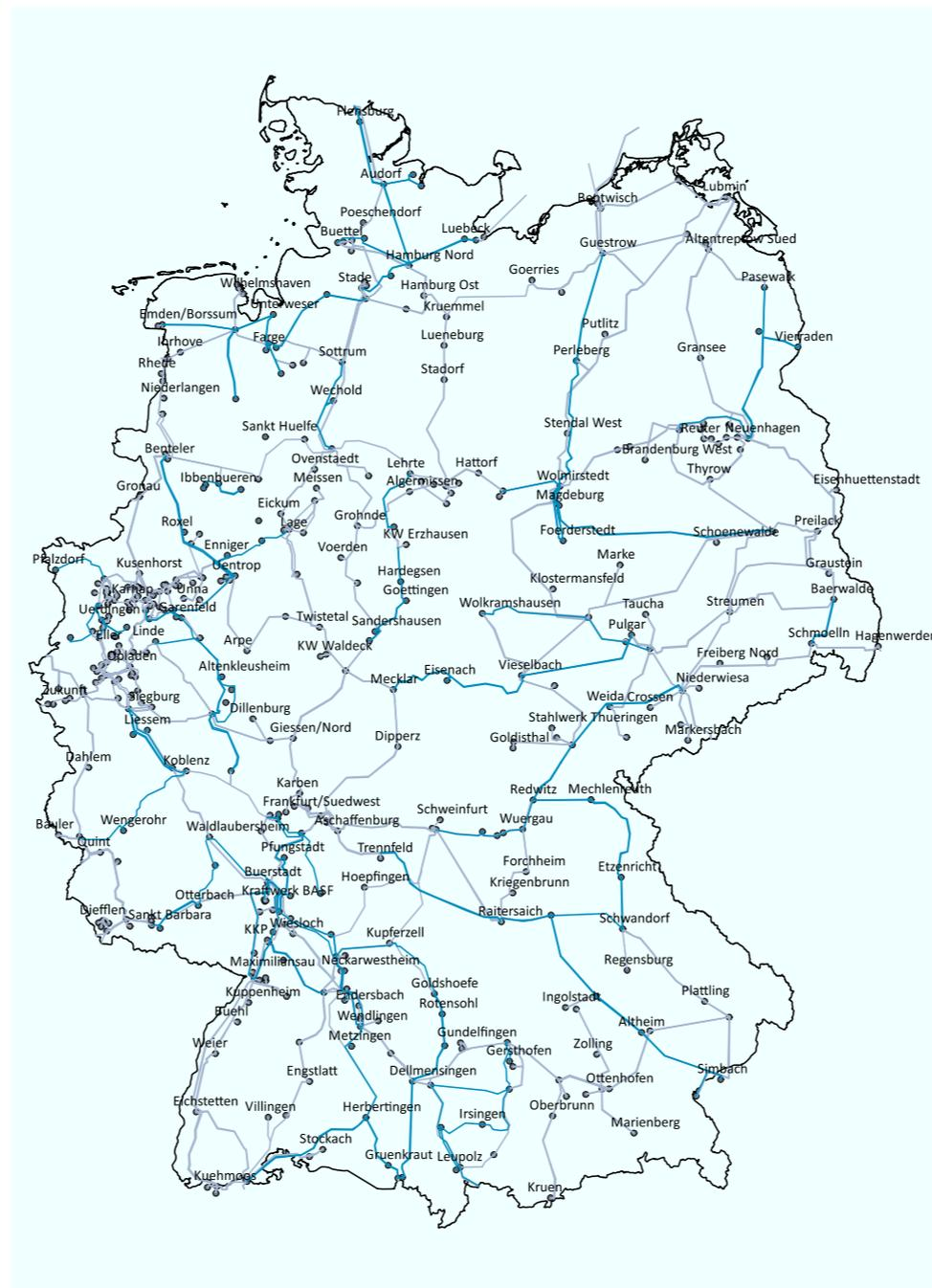
Abbildung 5.73: Topologie des modellierten deutschen Übertragungsnetzes für das Jahr 2012
