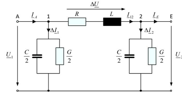
**Abbildung 2.12:  $\pi$ -Ersatzschaltbild einer elektrisch kurzen Leitung [41]**
