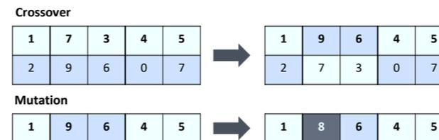
**Abbildung 5.57: Funktionsweise der genetischen Operatoren Crossover und Mutation [382]**
