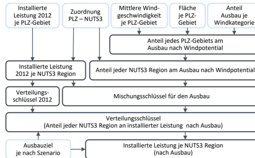
**Abbildung 5.23: Verfahrensablauf der Regionalisierung der installierten Windenergieleistung**
