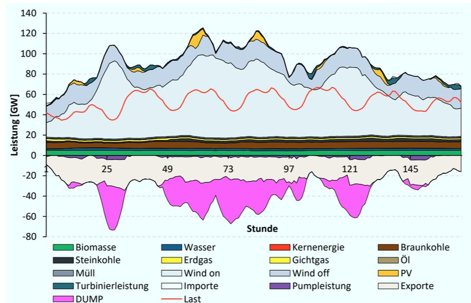
Abbildung B.31: Woche im Jahr 2035 mit Starkwind - Starklast (27) und Starkwind - Schwachlast (65) Stunde
