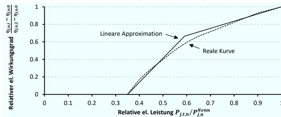
Abbildung 5.46: Relativer elektrischer Wirkungsgrad eines GuD-Kraftwerks im Teillastbetrieb [346]
