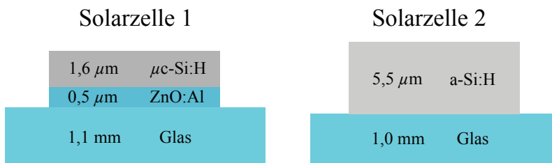
Abbildung 27: Schematische Darstellung der Schichtstrukturen von Solarzelle 1 und 2 mit mikrokristallinem Silizium ( \mu\text{c-Si} ) und amorphem Silizium (a-Si).
