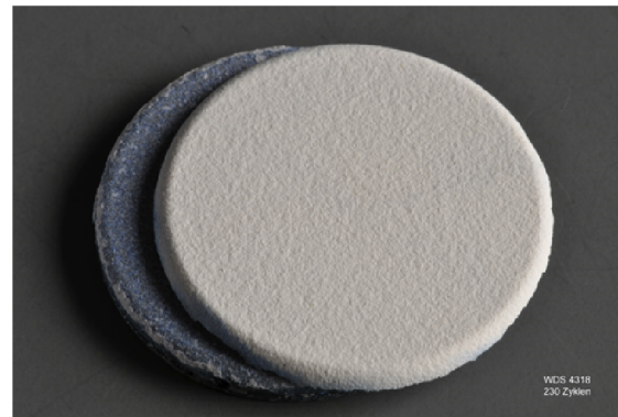
Abbildung 6.16: YSZ Wärmedämmschichtsystem mit 10 % ODS-Haftvermittlerschicht auf ERBO 1 Substrat und mit Amdry 995 Materialbasis nach Ofenzyklierung bei 1100 °C nach 230 Zyklen bei 2 h heizen 15 min kühlen (WDS4318 CV036)
