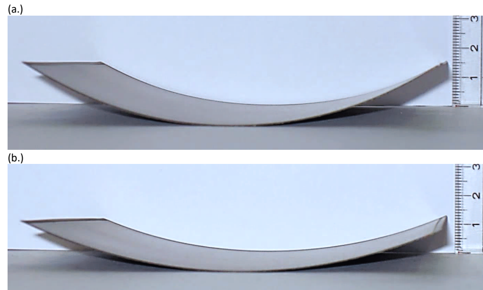
Abbildung 65: Substrate mit A-, B- und C-Ni/YSZ- Anodenschichten gesintert bei jeweils 1200°C, 3 h, H 2 (a.) ohne Beschwerung, (b.) mit Randbeschwerung
