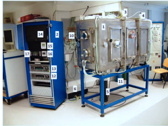
Abbildung 28: Pilotanlage zur Elektrolytbeschichtung über einen GFS-Prozess aus [63]
