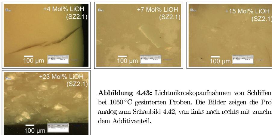
**Abbildung 4.43:** Lichtmikroskopaufnahmen von Schliffen der bei 1050°C gesinterten Proben. Die Bilder zeigen die Proben, analog zum Schaubild 4.42, von links nach rechts mit zunehmendem Additivanteil.
