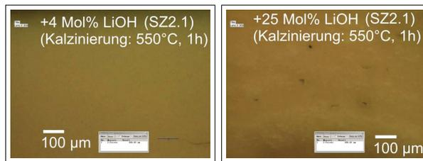
**Abbildung 4.45:** Lichtmikroskopaufnahmen von Schlifflinien der bei 1050 °C gesinterten Proben (Schaubild 4.44).
