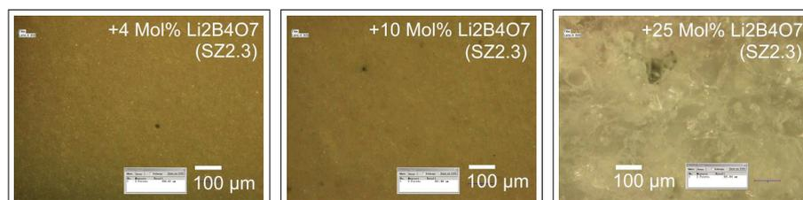
**Abbildung 4.49:** Lichtmikroskopaufnahmen von Schlifften der bei 1050 °C gesinterten Proben (Schaubild 4.48).
