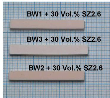
**Abbildung 4.41:** Bei 1050 °C gesinterte Stäbchenproben der Materialien aus Abbildung 4.40. Die Grünkörper hatten eine durch die Pressform vorgegebene Länge von 40 mm und eine Breite von 5 mm.
