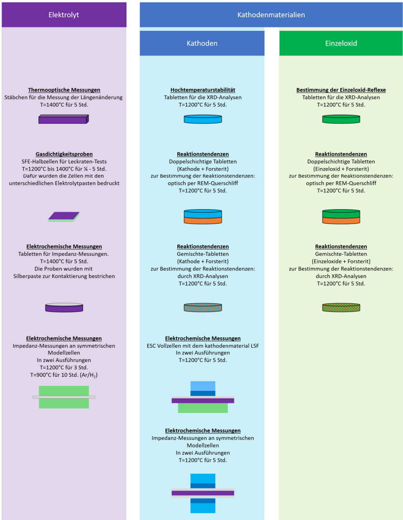
Abbildung 3-1: Übersicht der im Rahmen dieser Arbeit hergestellten Probenvariationen. Die unterschiedlichen Probengeometrien wurden jeweils auf die unterschiedlichen Analysemethoden angepasst.
