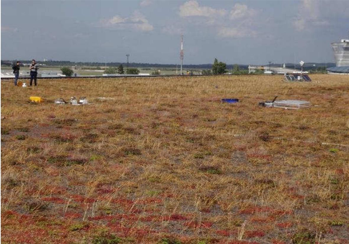
*Abbildung 11: Messungen auf extensivem Gründach. v.l.n.r.: Manuelle Respirationsmessung des Flächenmittelwerts auf einem Transekt aus 30 Punkten; automatische Messung von Bodenrespiration (unbewachsene Punkte), Gesamtrespiration (bewachsen) und Netto-CO<sub>2</sub>-Fluss NEE (bewachsen, transparente Haube); Tunnelhaube (NEE und Verdunstung); EC-Station der TU Braunschweig.*
