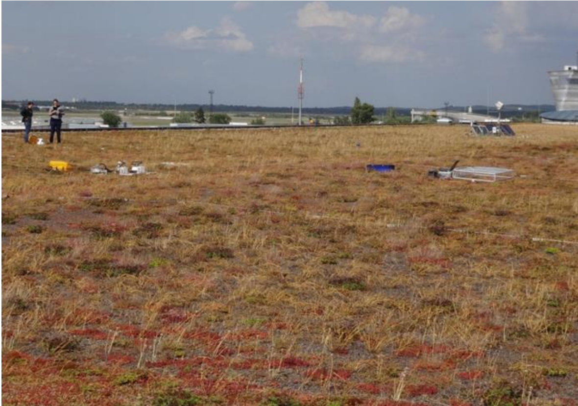
Abbildung 11: Messungen auf extensivem Gründach. v.l.n.r: Manuelle Respirationsmessung des Flächenmittelwerts auf einem Transekt aus 30 Punkten; automatische Messung von Bodenrespiration (unbewachsene Punkte), Gesamtrespiration (bewachsen) und Netto-CO 2 -Fluss NEE (bewachsen, transparente Haube); Tunnelhaube (NEE und Verdunstung); EC-Station der TU Braunschweig.
