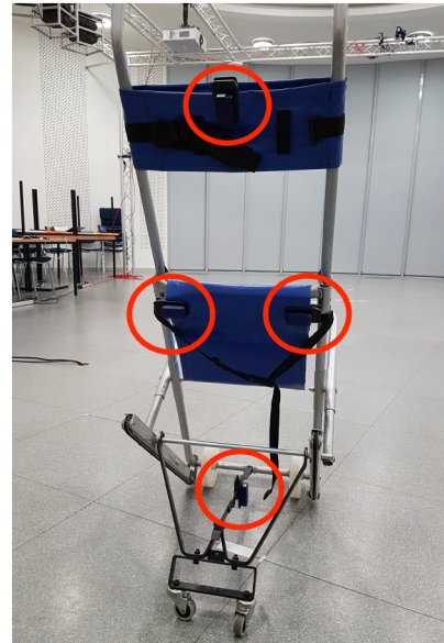
(b) Evakuierungsstuhl ausgestattet mit inertialen Sensoren
