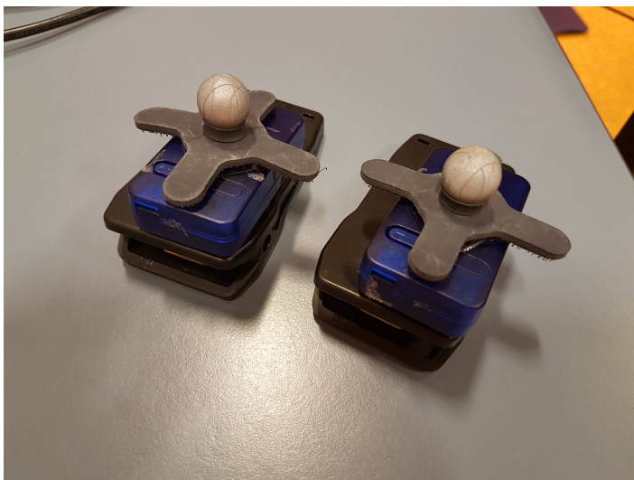
(a) Inertiale Sensoren versehen mit Markern des 3D-Tracking-Systems
