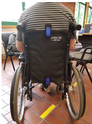
Abbildung 4 – Inertielle Sensoren in blau mit Hilfe von Klemmen an der Rückseite eines Rollstuhls befestigt
