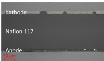
Abbildung 6: Rasterelektronenmikroskopieaufnahme des Querschnitts einer CCM basierend auf Nafion<sup>®</sup> 117
