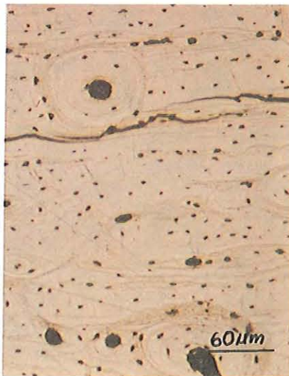
Abb. IV.18 Gaskontrastiertes Knochengefüge (Kaninchen, Sauerstoff, 13 Pa, Elektrodenabstand 11 mm, Pt-Kathode)
