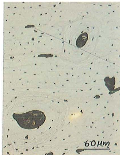
Abb. IV.18 Gaskontrastiertes Knochengefüge (Kaninchen, Sauerstoff, 13 Pa, Elektrodenabstand 11 mm, Pt-Kathode)
