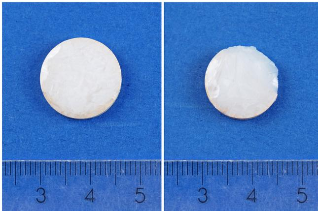
(d) C4, Porosität: 13,09% (Sintertemperatur: 1300 °C)      (e) C7, Porosität: 1,43% (Sintertemperatur: 1600 °C)
