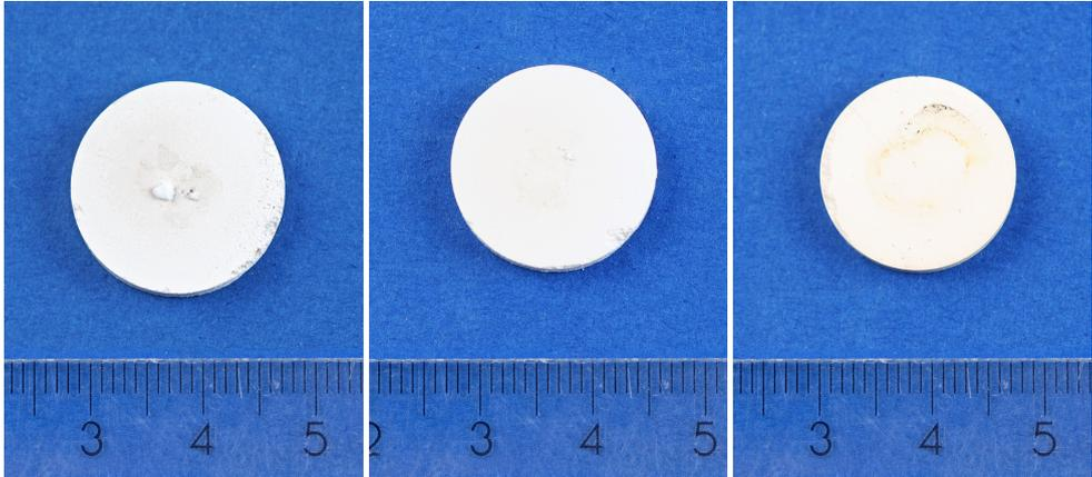
(a) C8, Porosität: 46,02% (Sintertemperatur: 1000 °C)      (b) C9, Porosität: 45,26% (Sintertemperatur: 1100 °C)      (c) C3, Porosität: 28,27% (Sintertemperatur: 1200 °C)
