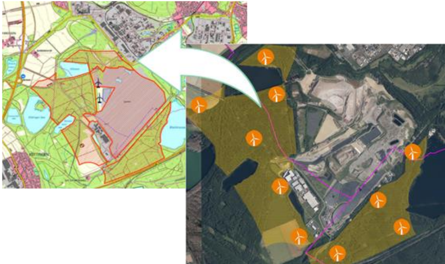
Abbildung 2.3: Potenzielle Flächen für Stromerzeugungsanlagen auf Basis von Windenergie und Photovoltaik im Umfeld des Knapsacker Hügels (rot-umrandete Zone) und eine exemplarische Anordnung von Windkraftanlagen
