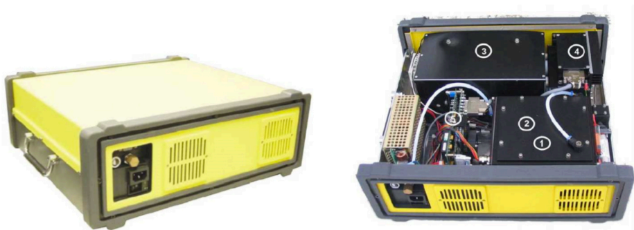
Abbildung 14 Aufbau und Komponenten des FT-IR-Gas-Analysators GASMET™ DX4000N von Asynco.
