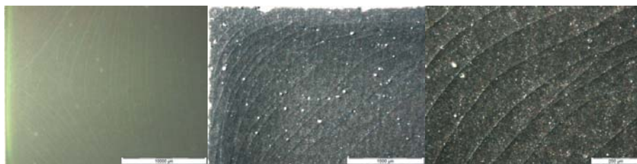
Abb. 3.11: Aufnahmen von Rissen im Elektrolyten reoxidiertter Proben mit einer Color View Soft Imaging System Digitalkamera durch ein Stereomikroskop des Typs SXZ 12 der Firma Olympus
