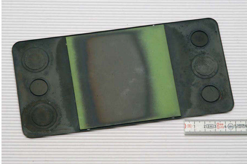
Abb. 4.34: Reoxidationsprofil einer Zelle in einer G-Design Halbkassette (Reoxidationsgrad 18%) nach einmaliger Reoxidation bei 800°C für 1h (Gaszuführung im Bild von rechts)
