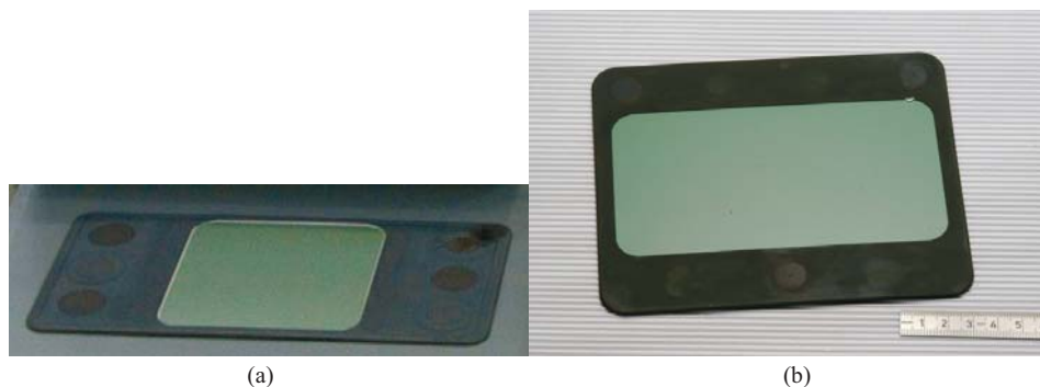
Abb. 3.3: Halbkassetten im Ursprungszustand, (a) G-Design, (b) CS-Design, (Elektrolytseite)
