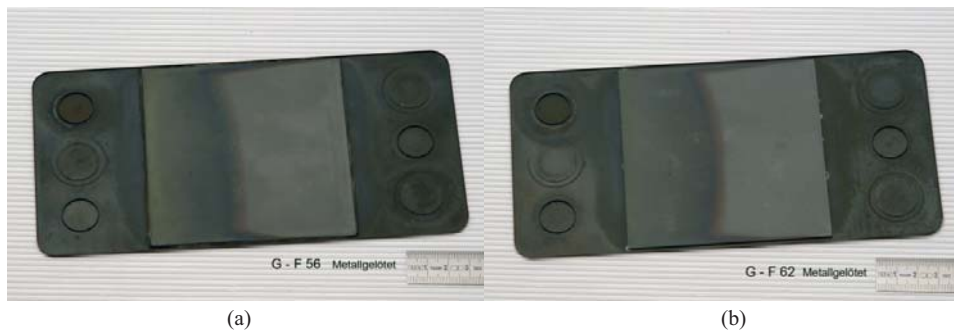
Abb. 4.48: G-Design Halbkassetten (Reoxidationsgrad 8%) nach einem Reoxidationszyklus bei 600°C mit einem Durchfluss von 0,37l/min für 10min, (a) mit Zellkantenversiegelung, (b) ohne Zellkantenversiegelung (Gaszuführung im Bild jeweils von links)
