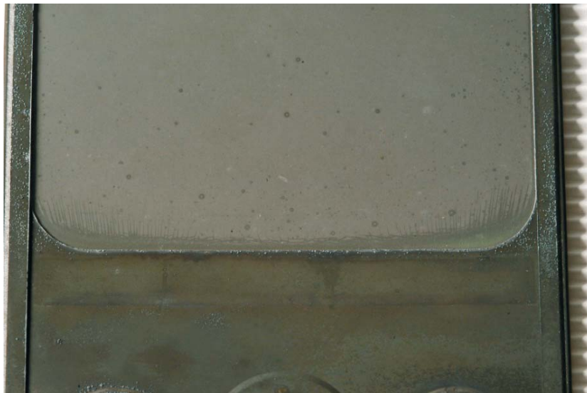
Abb. 4.35: Reoxidationsprofil einer Zelle in einer G-Design Halbkassette auf der Elektrolytseite (Reoxidationsgrad 18%) nach einmaliger Reoxidation bei 800°C für 1h (Gaszuführung im Bild von unten)
