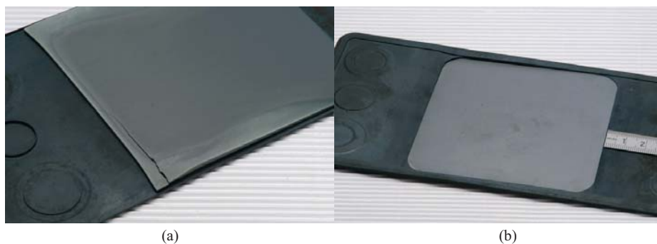
Abb. 4.33: G-Design Halbkassette (Reoxidationsgrad 4%) nach 50 Reoxidationszyklen bei 800°C mit 4,7l Luft n 160s, (a) Substratseite, (b) Elektrolytseite
