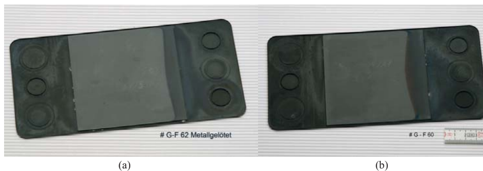
Abb. 4.46: G-Design Halbkassetten (Reoxidationsgrad 1,2%) nach einem Reoxidationszyklus bei 600°C für 10min, (a) kontinuierliche Luftzuleitung, (b) gepulste Luftzuleitung (Gaszuführung im Bild jeweils von rechts)
