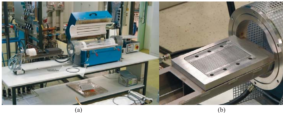
Abb. 3.10: Bilder des Messstandes für Reoxidationsversuche an CS-Design Halbkassetten, (a) Übersicht, (b) Probenaufnehmer
