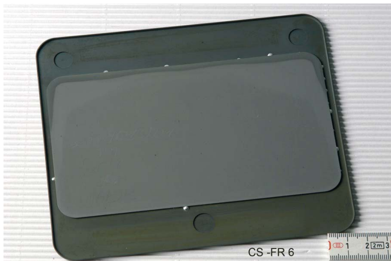
Abb. 4.40: CS-Design Halbkassette nach der Reoxidation bei 600°C für 10min mit einem Durchfluss von 0,037l/min (Gaszuführung im Bild von oben)
