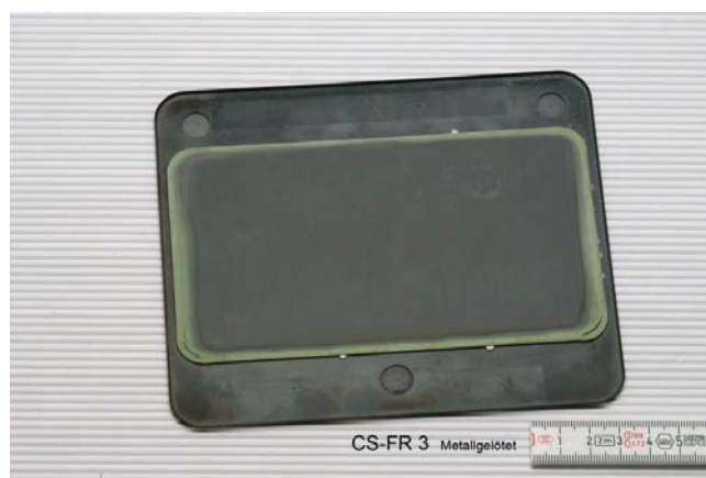
Abb. 4.38: Reoxidationsprofil einer Zelle in einer CS-Design Halbkassette (Reoxidationsgrad 10%) nach Reoxidation bei 800°C für 1h mit einem Luftdurchfluss von 0,06l/min (Gaszuführung im Bild von unten)
