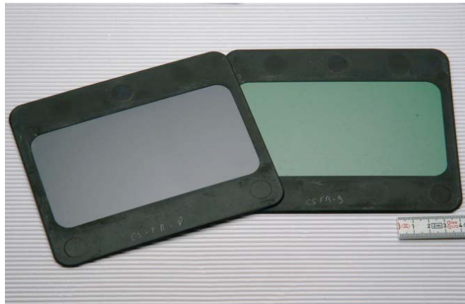
Abb. 3.4: Vergleich zweier CS-Design Halbkassetten vor (rechts) und nach (links) der vollständigen Reduktion im Messstand bei 800^\circ\text{C} (Elektrolytseite)
