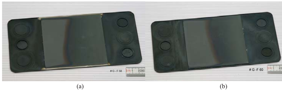
Abb. 4.50: G-Design Halbkassetten (Reoxidationsgrad 12,5%) nach einem Reoxidationszyklus bei 600°C mit einem Durchfluss von 0,42l/min für 10min, (a) mit Bypassversiegelung, (b) ohne Bypassversiegelung (Gaszuführung im Bild jeweils von rechts)
