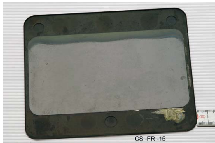
Abb. 4.42: CS-Design Halbkassette mit extern hergestellter Zelle nach einmaliger Reoxidation bei 600^\circ\text{C} für 10min mit einem Luftdurchfluss von 0,037\text{l/min} (Gaszuführung im Bild von oben)
