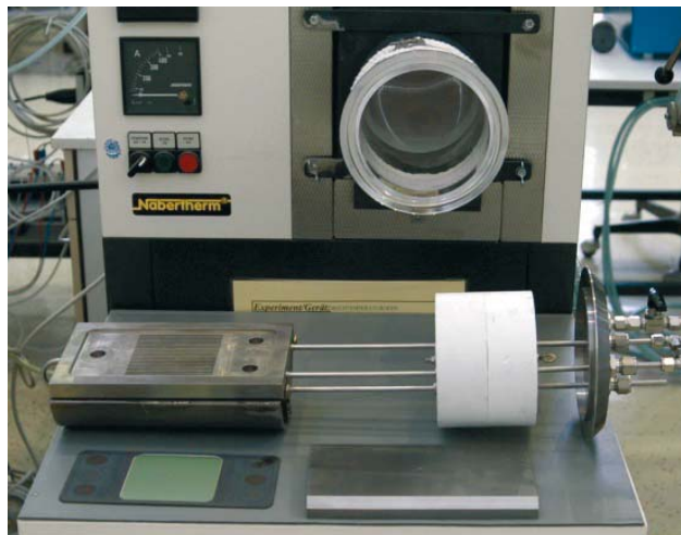
Abb. 3.8: Bild einer Probe und der Probenhalterung des Messstandes für Reoxidationsversuche an G-Design Halbkassetten, zugehöriger Ofen im Hintergrund
