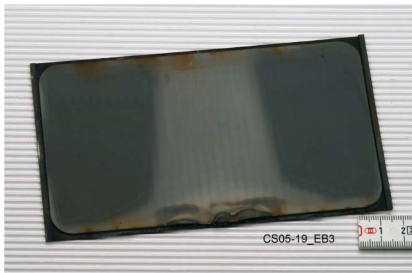
Abb. 4.56: Ebene 3 aus dem Stack CS05-19 nach 250 Redox-Zyklen bei 600 und 125 Zyklen bei 700°C
