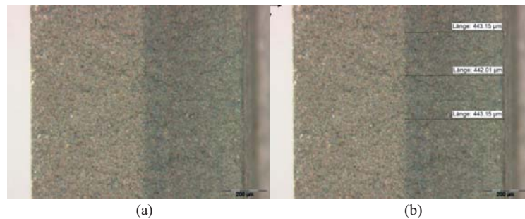
Abb. 3.12: Bruchfläche einer reoxidierten Probe unter dem Stereomikroskop, (a) Aufnahme, (b) Vermessung des reoxidierten Substratteils
