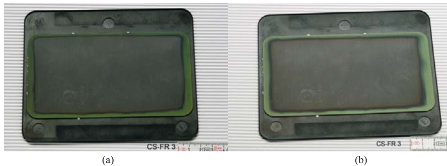
Abb. 4.37: Reoxidationsprofil einer Zelle in einer CS-Design Halbkassette (Reoxidationsgrad 9 bzw. 13%) nach Reoxidation bei 700°C für 1h mit einem Luftdurchfluss von 0,06l/min (Gaszuführung im Bild von unten), (a) nach dem ersten Zyklus, (b) nach dem zehnten Zyklus
