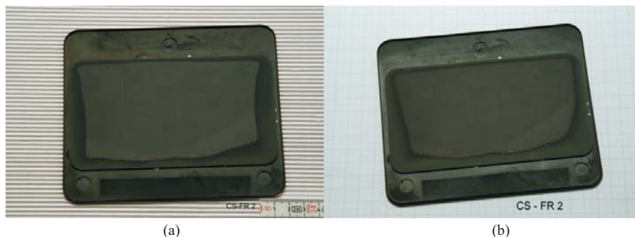
Abb. 4.36: Reoxidationsprofil einer Zelle in einer CS-Design Halbkassette (Reoxidationsgrad 10%) nach Reoxidation bei 600^{\circ}\text{C} für 1h mit einem Luftdurchfluss von 0,061/\text{min} (Gaszuführung im Bild von unten), (a) nach dem ersten Zyklus, (b) nach dem zehnten Zyklus
